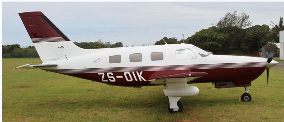
Piper PA-46-350P Malibu Mirage. Exemplo fabricado em 1988 com motor Lycoming TIO-540, de 350 hp's, bem como a hélice tri-pá e fuselagem pressurizada. Foto: Brian Spurr – Airliners.net
