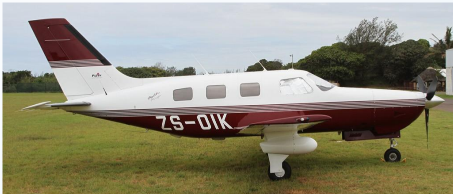
Piper PA-46-310P Malibu Mirage. Exemplar fabricado em 1988 com motor Lycoming TIO-540, de 350 hp's, bem como a hélice tri-pá e fuselagem pressurizada. Foto: Brian Spurr – Airliners.net
