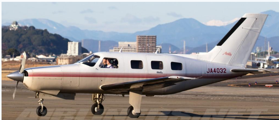
Piper PA-46-310P Malibu. Exemplar fabricado em 1987, com motor Continental e hélice bi-pá. Foto: Hajme Suzuki – Airlines.net
